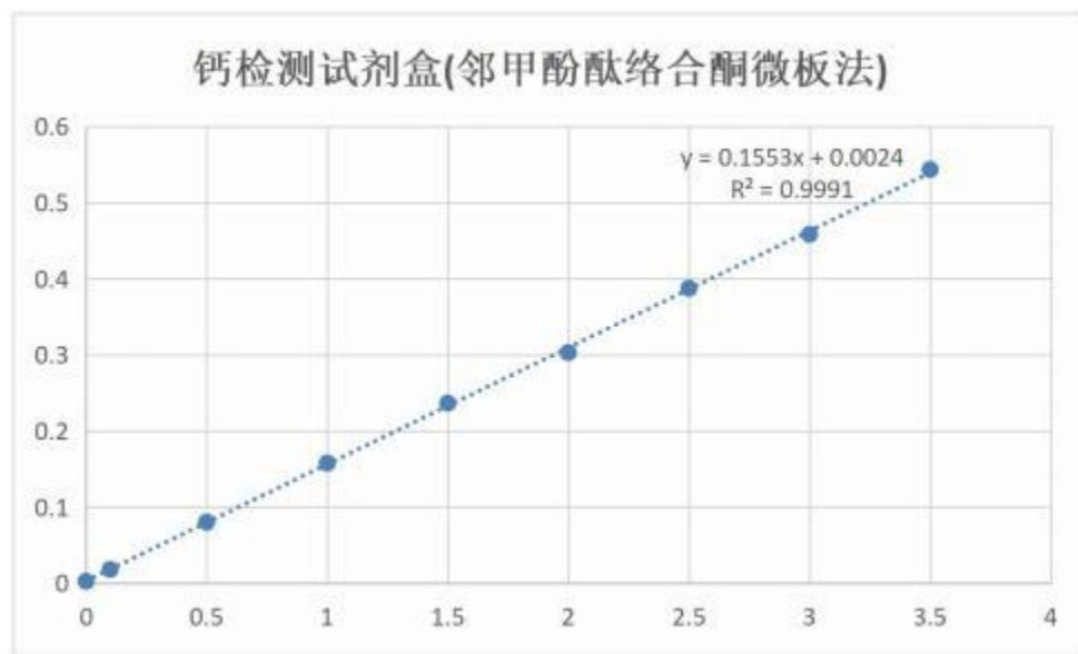
根据检测结果我们建议 0.1~3mM 的样品可以直接检测, 3mM 以上的样品根据初检结果做适当稀释再次检测。
